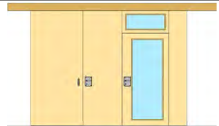
Servicetüre mit Glasfeldern
